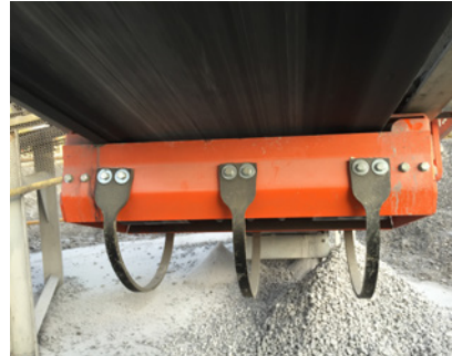
L'Optim'Force 6® garantit le centrage de la bande, même pour les applications sévères
